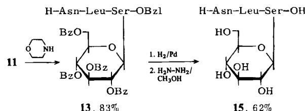
Nach Hydrogenolyse der Benzylgruppe in **13** lassen sich die Benzoylgruppen mit Hydrazinhydrat in Methanol bei Raumtemperatur so schonend abspalten, daß die empfindliche *O*-glykosidische Bindung vollkommen erhalten bleibt. Die Struktur des freien Glucotripeptids **15** ist NMR-spektroskopisch gesichert.
